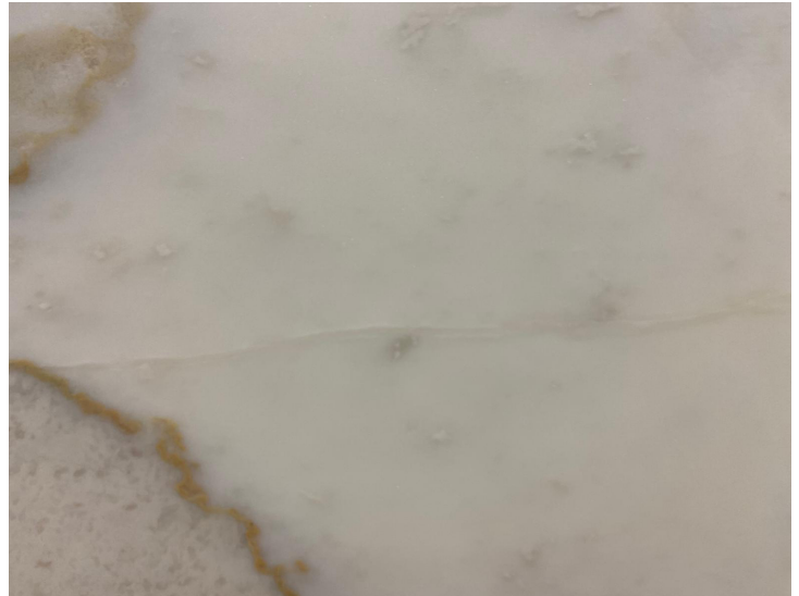
Risse und Harzfüllung.
